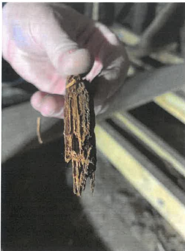
Zdjęcie 20. Widok zniszczonego fragmentu belki ze zdjęcia 18. (rozkład brunatny).
