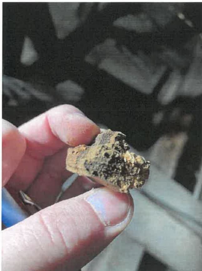
Zdjęcie 19. Widok zniszczonego fragmentu belki ze zdjęcia 18. (rozkład brunatny)
