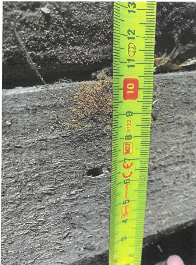
Zdjęcie 16. Widok otworu wlotowego oraz mączki drzewnej.
